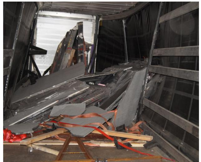
Aufgrund der Spurenlage konnte davon ausgegangen werden, dass der Notbremsassistent durch eine abrupte Vollbremsung einen Zusammenstoß auf das vorausfahrende Fahrzeug und damit einen schweren Verkehrsunfall verhindern konnte; gleichzeitig war die maximale Bremsverzögerung aber auch kausal für das komplette Versagen der unzureichenden Ladungssicherung und damit das völlige Zerstören der wertvollen Ladung.
